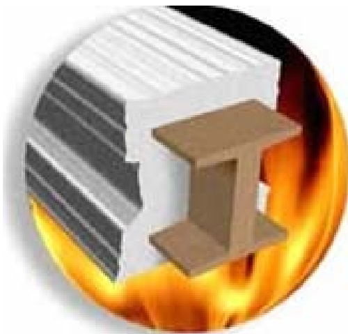
Expansión de la pintura intumescente en un perfil de acero debido al efecto del calor
